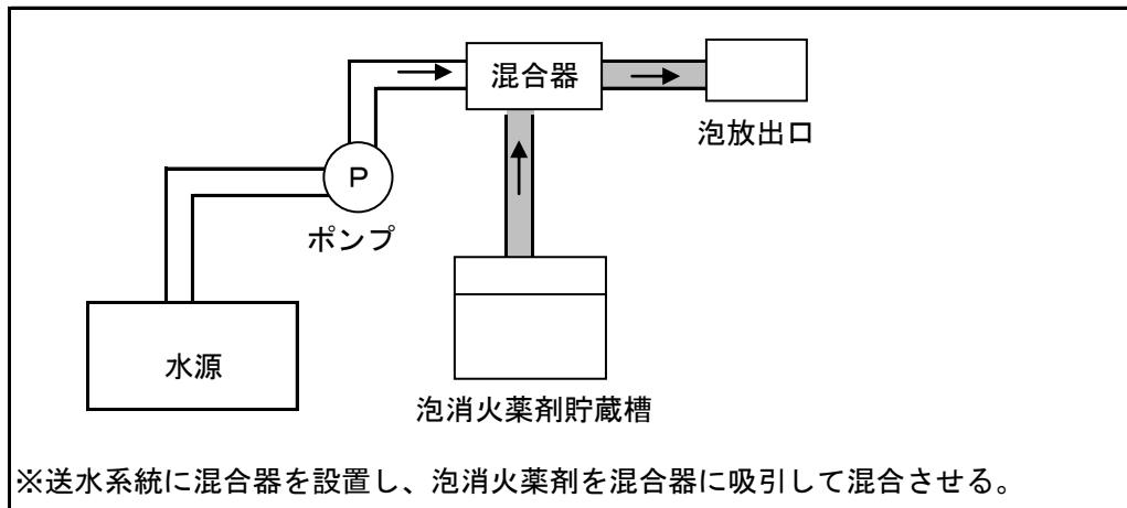
イ プレッシャー・サイド・プロポーショナー方式の混合器（2管式のものに限る。）は、泡放射用器具の格納箱に収納するか、又はその直近（おおむね5m以内）に設置すること。
