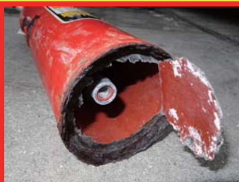
宇土市で破裂した消火器(実物)
