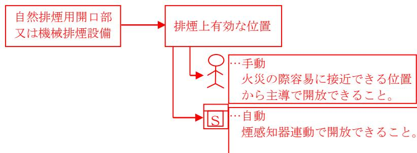
(a) 自然排煙用開口部については、その面積の合計が $1\text{ m}^2$ 以上であり、かつ、屋根又は天井に設けるものにあっては、渡り廊下の幅員の3分の1以上の幅で長さ $1\text{ m}$ 以上のもの、外壁に設けるものにあっては、その両側に天井面から $1.5\text{ m}$ 以内の位置に渡り廊下の3分の1以上の長さで高さ $1\text{ m}$ 以上のものその他これらと同等以上の排煙上有効な開口部を有するものであること。
