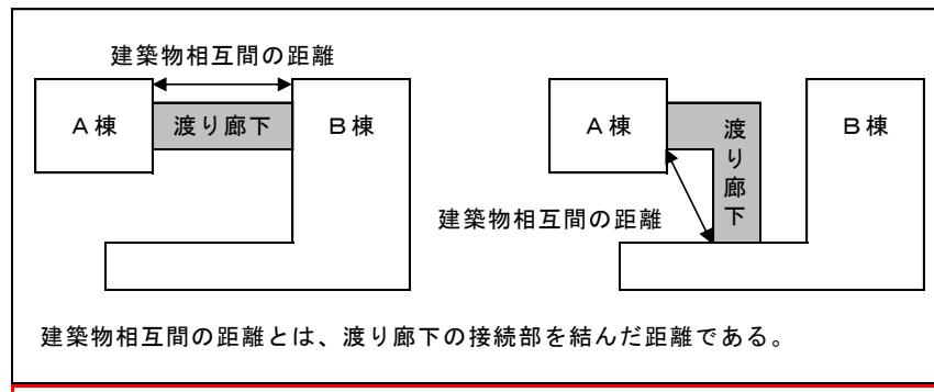
建築物相互間の距離とは、渡り廊下の接続部を結んだ距離である。
