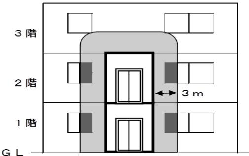
例 2 の場合は、4つの開口部の■の合計面積が  $4\text{ m}^2$  以内となる必要がある。
