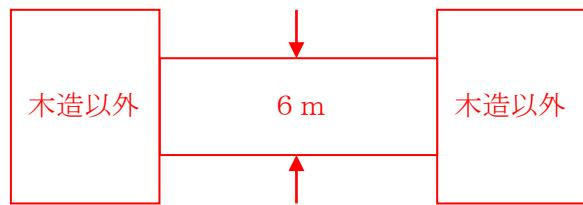
(3) 接続される建築物相互間の距離（高低差又は直線以外の形状を有する場合の距離は、水平投影距離とする。以下この第3において同じ。）は、1階にあっては6m、2階以上の階にあっては10mを超えるものであること。ただし、次のアからウまでに適合する場合は、この限りでない。
