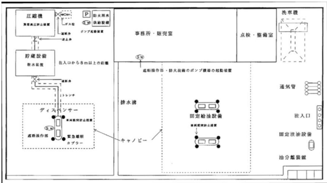
1-1 圧縮天然ガス等充填設備設置給油取扱所のモデル図
