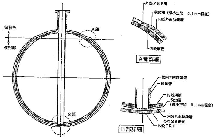
別図—1 鋼製強化プラスチック製二重殻タンクの構造例
