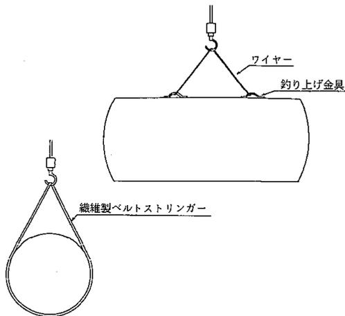
別図—2 (その1) 吊り下げ作業法の例
