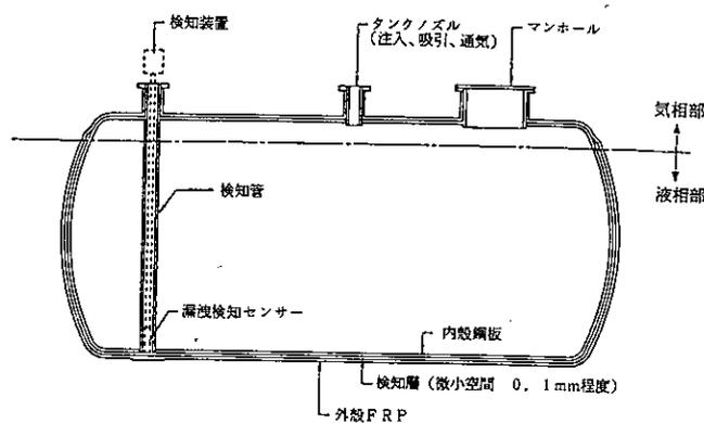
第3.3 鋼製強化プラスチック製二重殻タンクに係る規定の運用
