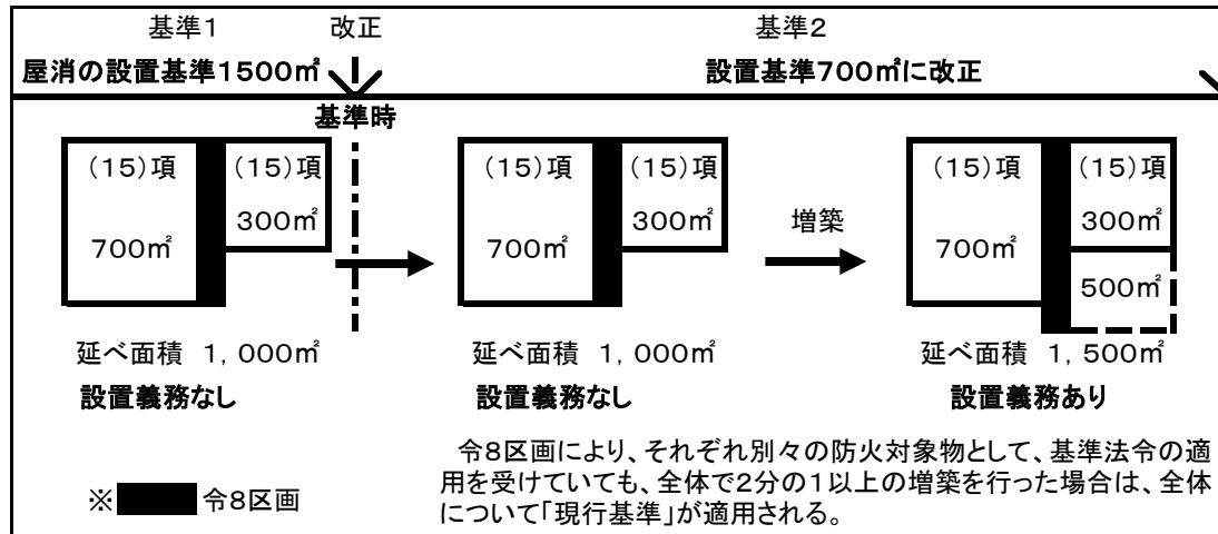
(イ) 令第34条の2第1項に規定する「床面積の合計」は、基準時以後に工事着手した増築又は改築部分の床面積すべての合算によること。
