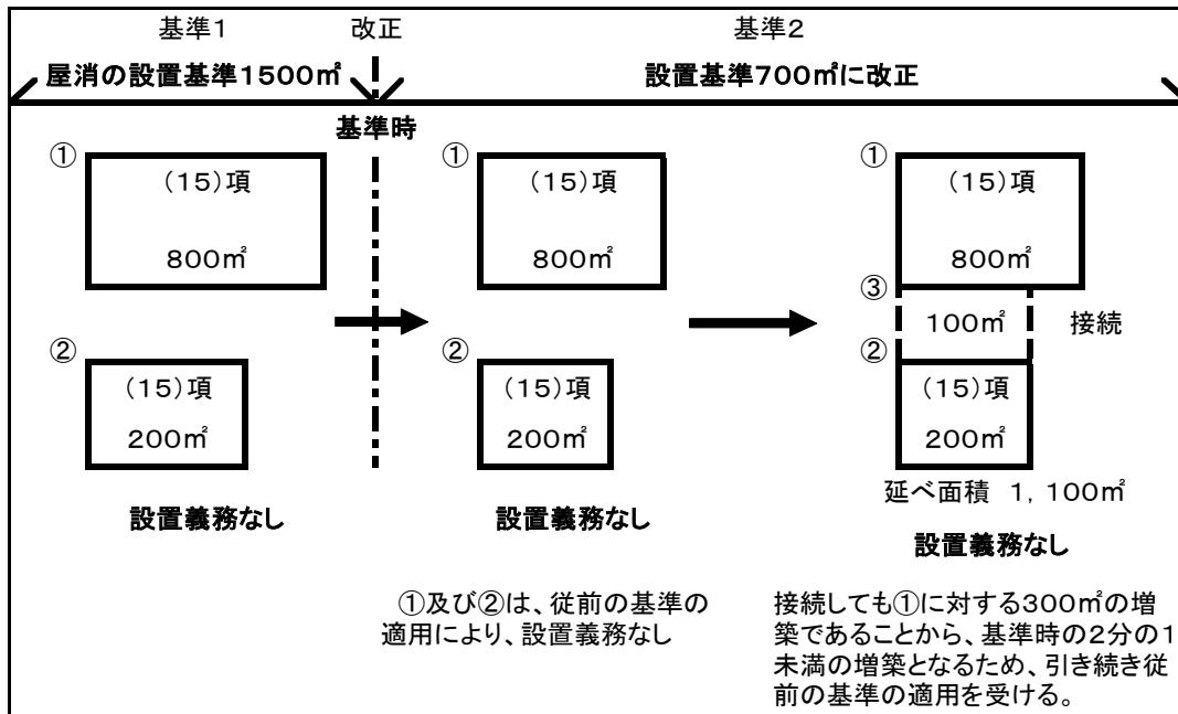
(イ) 令別表第一各項の占める床面積、又は各項の用途内において各用途の占める床面積の増加が行われても、棟の増築が行われていない場合は、法第17条の2の5第2項第2号に規定する増築には該当しない。この場合において、法第17条の2の5第2項第2号に規定する改築に該当する場合は、現行基準に適合させなければならない。
