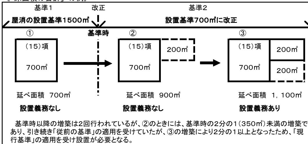
(ウ) 増築により複数の棟が接続された場合は、接続が行われる前に最も延べ面積が大きかった棟が増築されたものとすること。この場合において、基準時は、当該主となる棟の基準時によるものとする。
