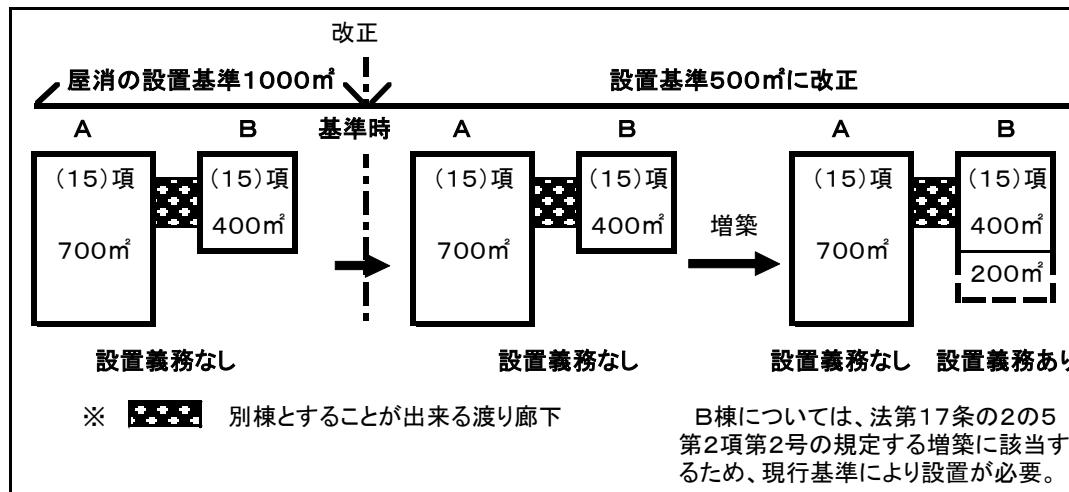
イ 渡り廊下部分及び接続される棟は、それぞれ独立した棟として規制されることから、既存棟を渡り廊下で接続しても各棟の増築とはならない。
