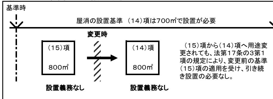
イ 複合用途防火対象物のいずれかの用途が別の用途へ変更された場合は、法第17条の3第1項の規定に該当する。
