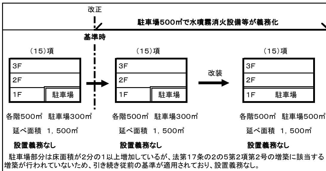
(オ) 法第17条の2の5第2項第2号の規定に該当しない規模の増改築の結果、従前の基準によって消防用設備等の義務が生じることとなる場合は、現行基準
